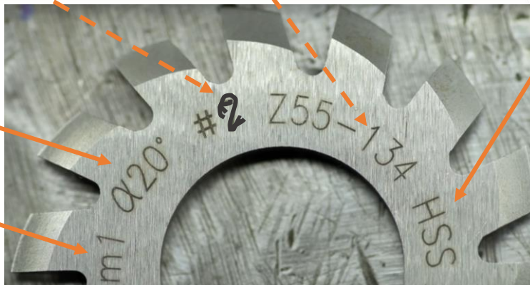
Σχήμα 5.39: Κοπή οδοντώσεων σε φρεζομηχανή: α) με δισκοειδή φρέζα μορφής, β) με κονδύλι μορφής.
