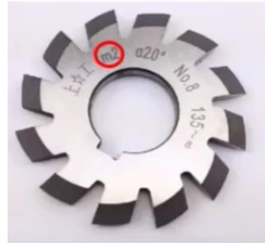
Πίνακας 5.14: Επιλογή δισκοφρεζών σε σχέση με τον αριθμό δοντιών της οδόντωσης για δεδομένο μέτρο οδόντωσης m .
